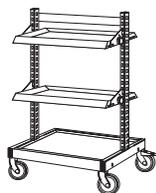
Largeur de module de 655 mm, avec 2 tablettes de rangement inclinables - 615 x 410 mm, 1 tablette inférieure
