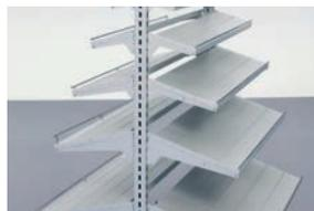
Tablettes à lamelles facilement réglables dans la zone de travail supérieure. Pas de réglage de 42 mm. Profondeur des tablettes à lamelles : 107, 214, 321, 428 et 535 mm. Inclinaison +10° et -16°.
