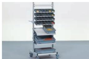
Tablettes de rangement d'un seul tenant à hauteur, profondeur et inclinaison réglables (jusqu'à 25 °). 3 largeurs de module et profondeurs de 460 (400) et 660 (600) mm permettent de créer un système kanban miniature. Les rails portebacs pour les bacs de stockage transparents facilitent la préparation des commandes.
