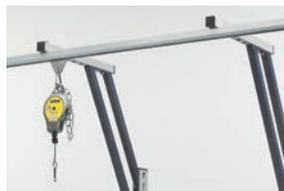
Mise à disposition des outils de montage dans la position souhaitée.
